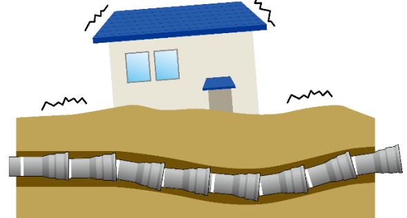
耐震化している水道管の場合
